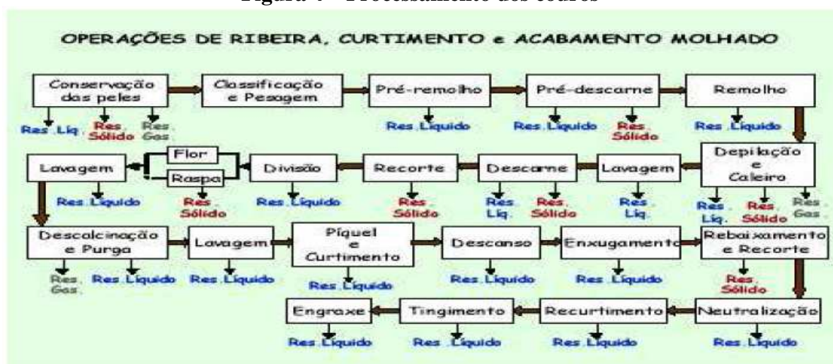
Figura 4 – Processamento dos couros
